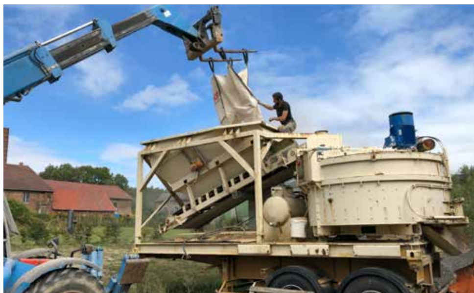
Le mélange est versé dans la centrale mobile de malaxage.
